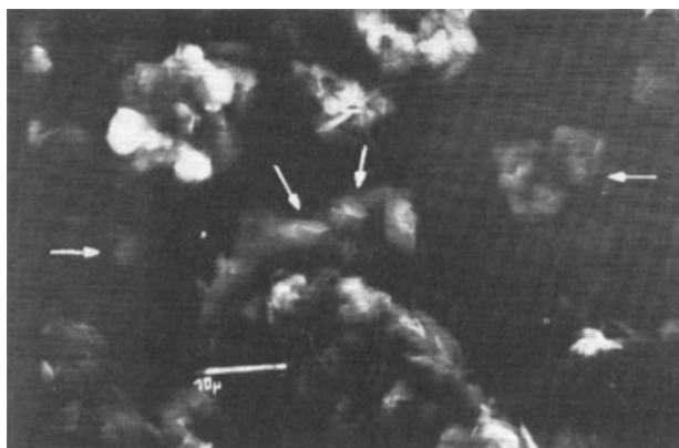
Abb. 3. REM-Aufnahme von [(Ru_{13})_{13}]_n -Kristalliten, vermischt mit Ru_{\infty} . Die Pfeile weisen auf besonders gut ausgebildete Sechsringflächen.
